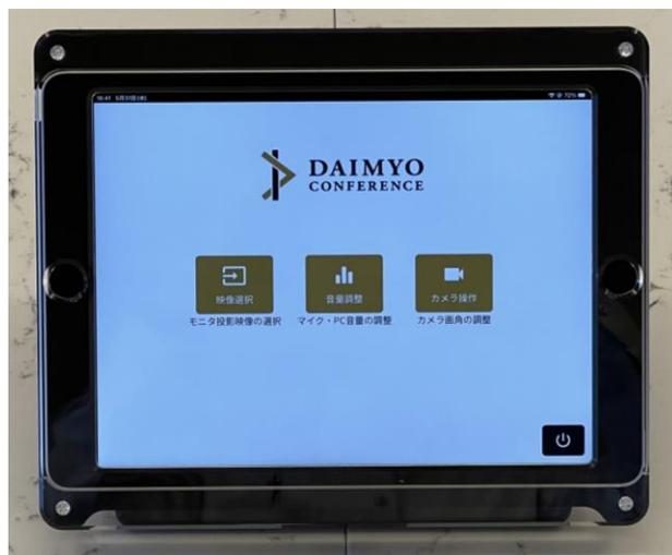
映像の切替・カメラ操作・音響の調整等は、タッチパネルで一括操作が可能です。
